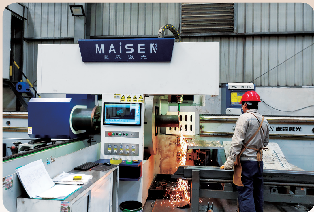
技术先进的激光切管机在加工作业
